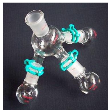
32. ábra - Több frakció gyűjtésére szolgáló előtét palackokkal
