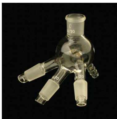
31. ábra - Több frakció gyűjtésére szolgáló előtét
