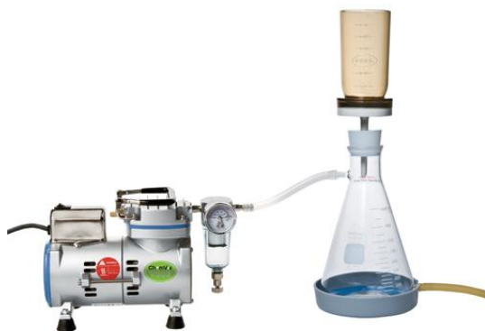
22. ábra - A vákuumszűrés
