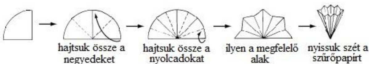
21. ábra - A redős szűrőpapír hajtogatása
