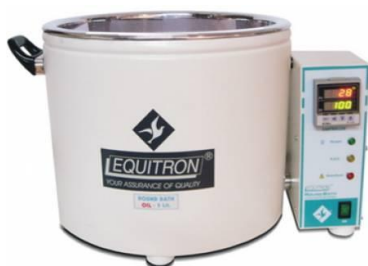
7. ábra - Elektromos olajfürdő
