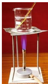
4. ábra - Légfürdő Bunsen-égő és drótháló felhasználásával
