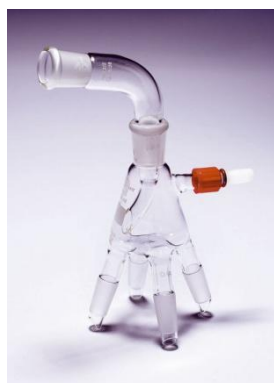
30. ábra - Több frakció gyűjtésére szolgáló előtét golyaorral
