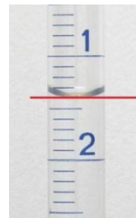
70. ábra – A helyes leolvasás pontja homorú meniszkusz esetén
