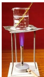
76. ábra – Légfürdő Bunsen-égő és drótháló felhasználásával
