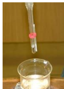
82. ábra – Olvadáspontmérés egyszerű módon – a kapilláris rögzítése
