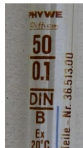
67. ábra – Egy bürettáról készült képrészlet, melyről leolvasható, hogy az eszköz kifolyásra kalibrált, 50 ml-re kalibrálták 20 °C hőmérsékleten
