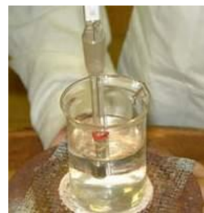
83. ábra – Olvadáspontmérés egyszerű módon – a konkrét mérés
