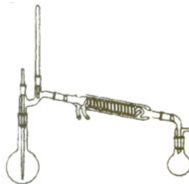
12. ábra Csiszolatos vákuumdesztilláló készülék Claisen-feltéttel
